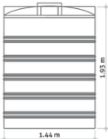
*Rotomoldeo con polietileno de alta calidad con PEAD (HDPE) para mayor resistencia y durabilidad*
