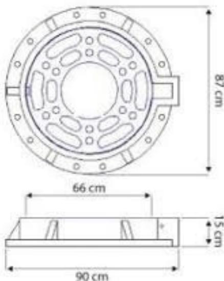
Este brocal y tapa para pozo de vista de tráfico vehicular ligero está fabricado con polietileno, siendo ecológico y fácil de instalar. Ofrece un área de apoyo de 12 cm y protección UV. Sus cartabones internos aseguran resistencia a cargas dinámicas, con una boca de entrada de 53 cm. Personalizable con logotipo y leyenda.
