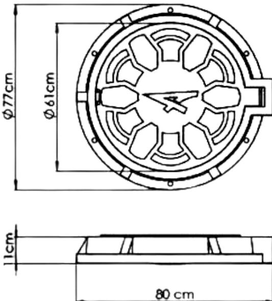
Este brocal y tapa para pozo de vista de tráfico vehicular ligero está fabricado con polietileno, siendo ecológico y fácil de instalar. Ofrece un área de apoyo de 12 cm y protección UV. Sus cartabones internos aseguran resistencia a cargas dinámicas, con una boca de entrada de 53 cm. Personalizable con logotipo y leyenda.
