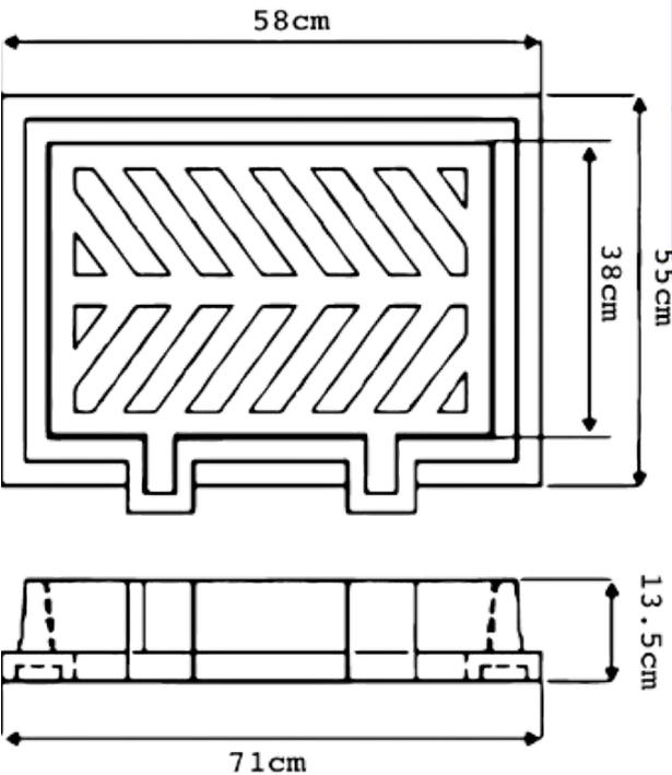
Este marco y rejilla boca de tormenta, está fabricado con material reciclado y es fácil de instalar. Ofrece protección contra rayos UV, cuenta con refuerzo en la tapa y en el marco. Por su menor peso son fáciles de transportar
